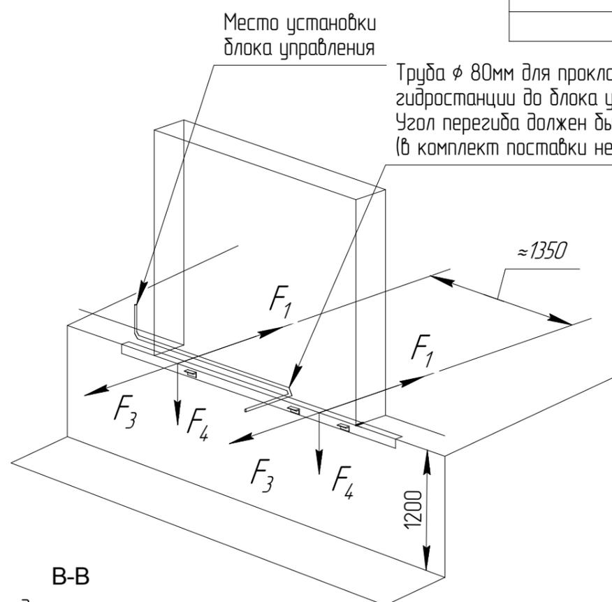
Труба  $\phi$  80мм для прокладки кабеля от гидростанции до блока управления.
